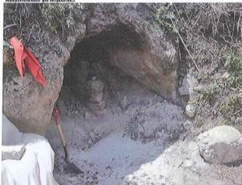
Foto 3. Horno de cal provisional dentro del área minera
